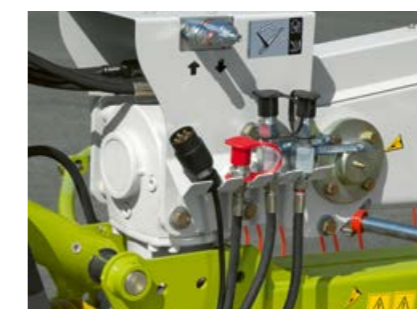
Serienmäßig hydraulische Folgesteuerung für zeitlichen Versatz zwischen vorderem und hinterem Kreisel beim Ausheben und Absenken.
