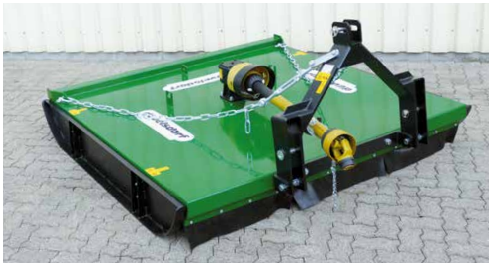
Sichelmulcher mit Gelenkwelle und Spannketten
