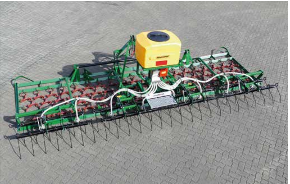
Grünlandegge mit Striegelfeld und Säeinrichtung | S. 15
