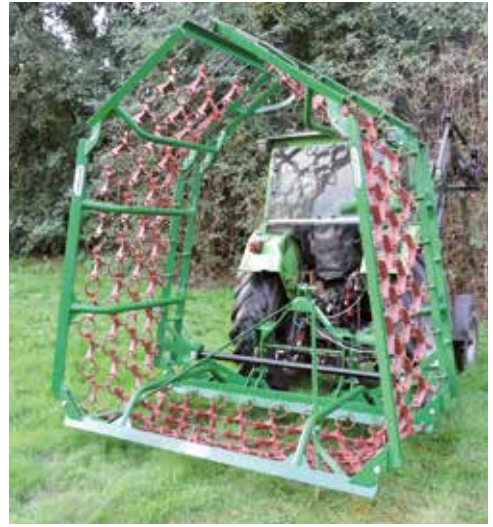
Grünlandegge 8,00 m, 4-reihig, hydraulisch klappbar
