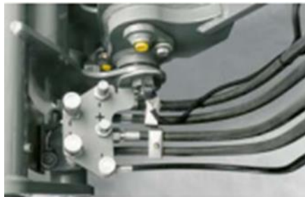
Abb. 7-3: Beispiel für Hydraulikanschlüsse eines Front-, Hof- oder Radlader
