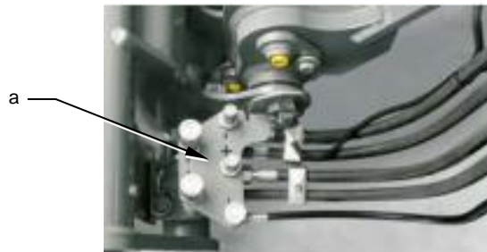
Abb. 4-18: Beispiel Hydraulikanschlüsse am Teleskoplader
