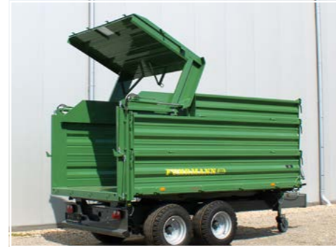
Hydraulische Rückwandöffnung mit zwei doppelwirkenden Zylindern
