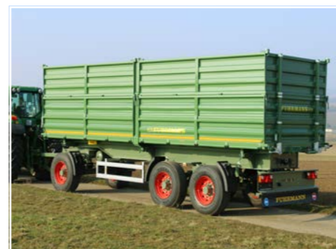
3-Achs-2-Seitenkipper 24 to - 40 km/h 8000 x 2480 x 1800 mm
