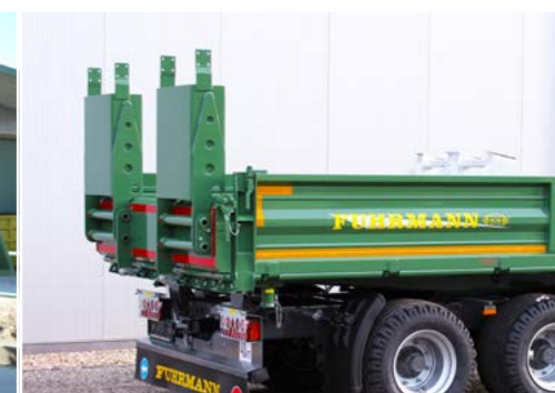
Konsolen für optionale Auffahrtrampen auf hydr. Rückwandklappe
