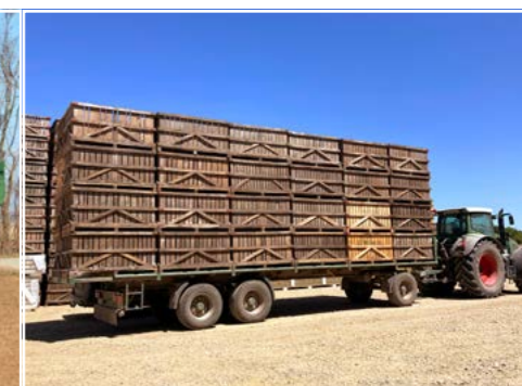
3-Achs Plateauanhänger 24 to - 40 km/h - 10200 x 2550 mm mit mech. Ausschubverlängerung
