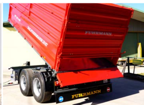
Hydraulische Rückwandklappe 400 mm hoch (geöffnet)
