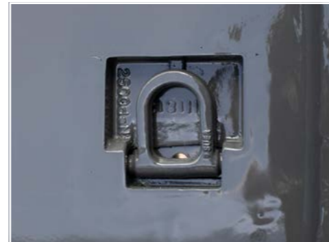
Zurmulde im Boden versenkt, 2500 kg DIN EN 12640
