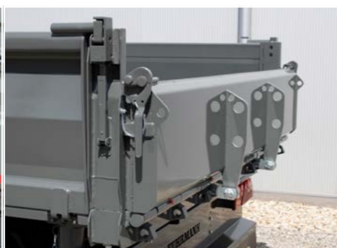
Hydraulische Rückwandklappe 400 mm hoch (geschlossen)
