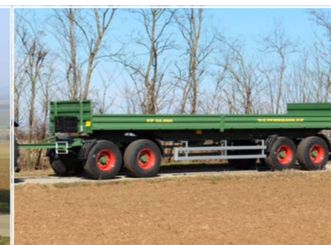
4-Achs Plateauanhänger 32 to - 40 km/h 9300 x 2550 mm
