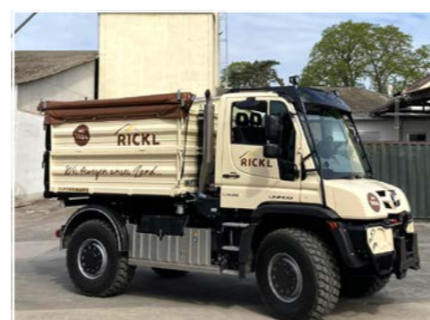
3-Seiten Kippaufbau auf Unimog U5435 für den Getreidetransport
