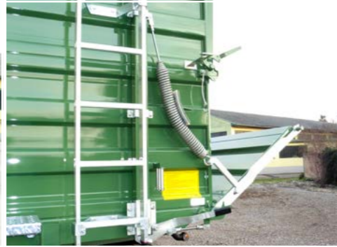
Bordwandhebefedernsystem für 800 mm Bordwände (teilabgeklappt)
