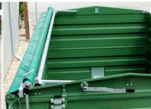
Klappbares Mittelrohr für Planenaufbau
