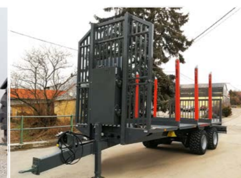
Tandem-Heckkran-Rückewagen 21 to - 40 km/h 5800 x 2480 mm mit EXTE-Steckungen
