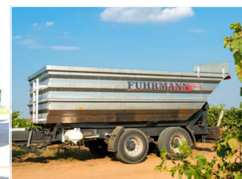
Tandem Niro-Muldenrückwärtskipper 18 to - 25 km/h Muldeninhalt: ca. 14.500 Liter
