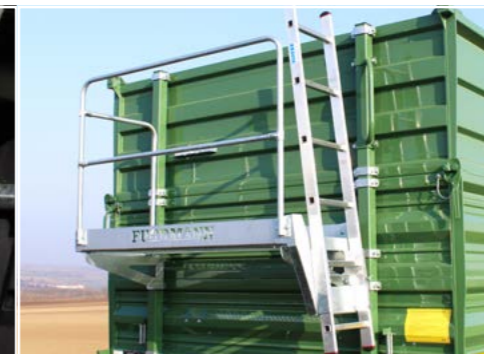
Bedienplattform an Stirnwand mit Sicherheitsgeländer
