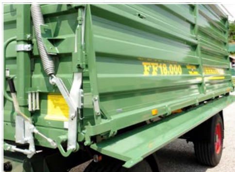
Seitliche Rübenrutsche, Höhe 360 mm, links / rechts umsteckbar
