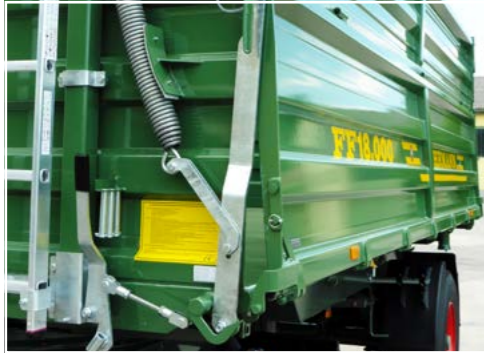
Bordwandhebefedernsystem für 800 mm Bordwände (Pendelbetrieb)
