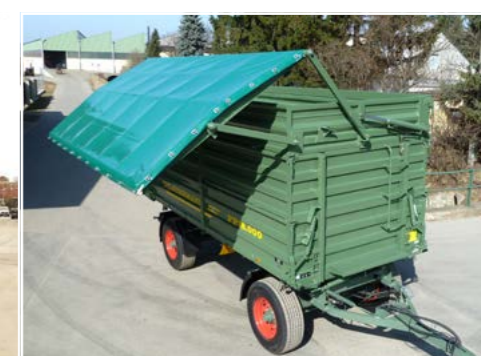
2-Achs 3-Seitenkipper 18 to - 40 km/h 5150 x 2480 x 2200 mm (Vollhydr. Planenaufbau)
