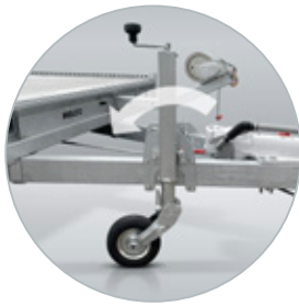
Zubehör; Klappbares Stützrad ermöglicht Weiterfahrt
