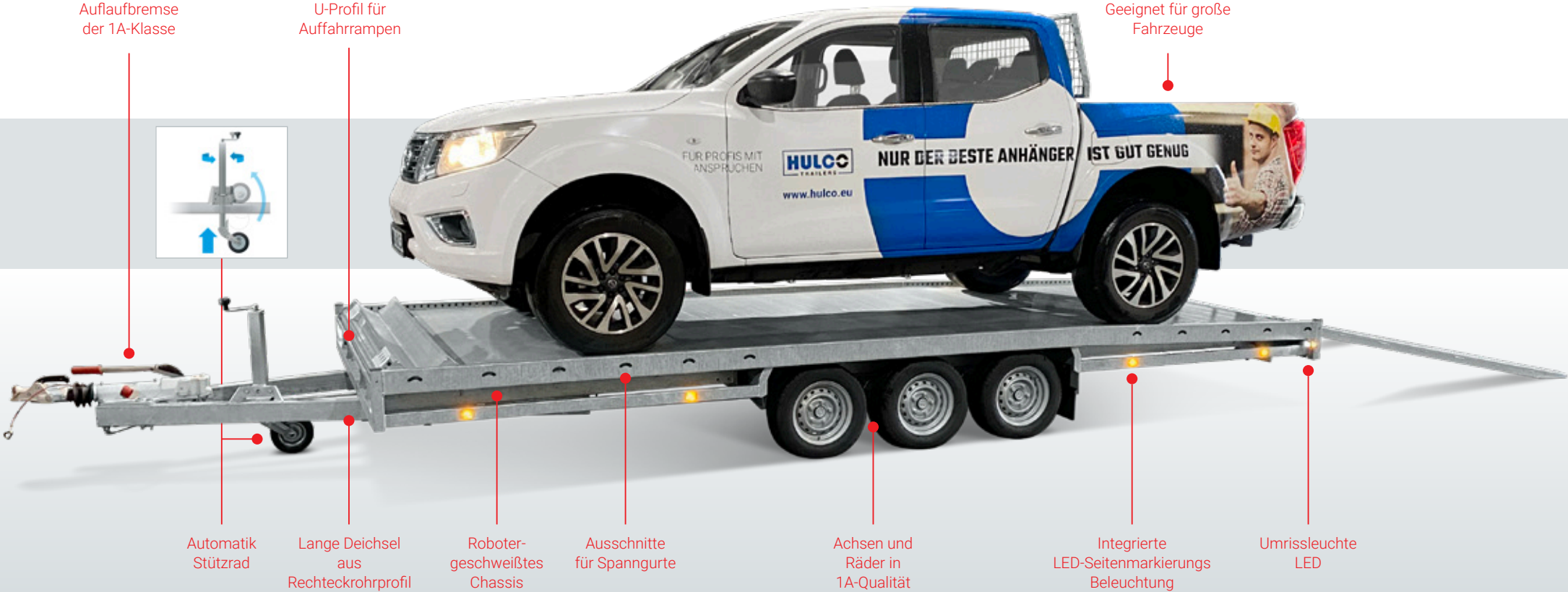
Extrem stabiles Fahrgestell mit optimaler Bodenunterstützung
