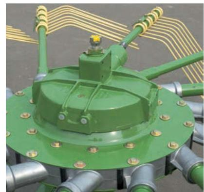
Wartungsfrei und dauergeschmiert: Denn die Swadro-Kreisel werden über rundum geschlossene Kegelradantriebe mit Fließfettfüllung angetrieben. Das gewährleistet eine stets gleichmäßige und optimale Schmierung. Das Abschmieren per Fettpresse entfällt.
