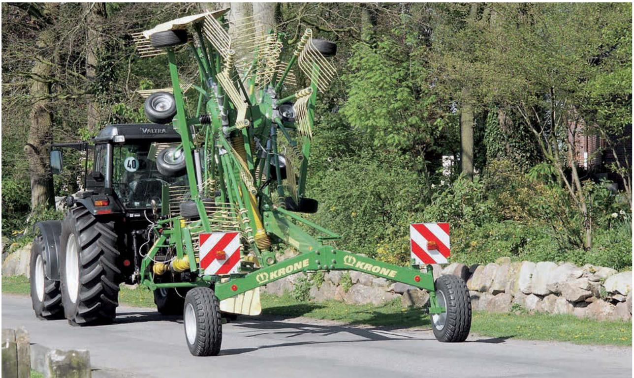
Mit 40 km/h kompakt und sicher über die Straße: Zum Befahren öffentlicher Wege unter niedrigen Brücken und Toreinfahrten, Leitungen und Ästen lassen sich die oberen beziehungsweise äußeren Zinkenarme einklappen.
