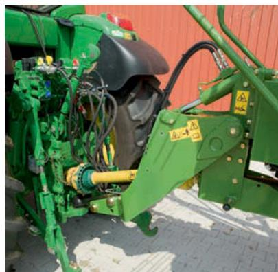
Optional: Die in der Höhe hydraulisch verstellbare Deichsel mit Kugelkopfkupplung für den Swadro 1400. Die Maschine lässt sich leicht an- und abkoppeln. Der Traktor benötigt keine Unterlenker. Sie fahren völlig ruckfrei, sicher und mit höchstem Komfort.
