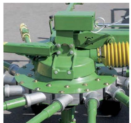
Stufenlos die Arbeitstiefe einstellen: Per Spindel lässt sich in der Grundausstattung die Arbeitstiefe schnell und bequem einstellen. So ist unter allen Bedingungen beste Recharbeit gewährleistet.
