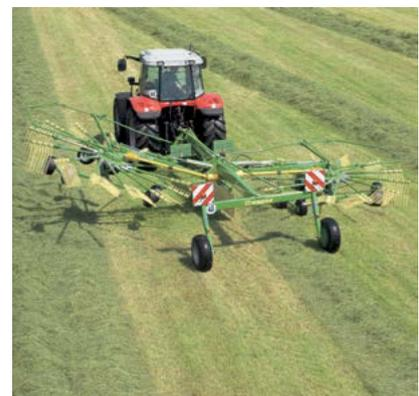
Variabel in der Breite: Ein passendes Schwad für die nachfolgende Erntemaschine steigert deren Leistung und reduziert die Verfahrenskosten. Doppeltwirkende Hydraulikzylinder ermöglichen am Swadro 800/26 Plus und 900 Plus die stufenlose Arbeits- und Schwadbreitenverstellung.
