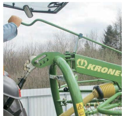
Bequeme Verstellung: Die Arbeitstiefeinstellung des Kreisels erfolgt stufenlos. Das geschieht schnell und einfach per Handkurbel vom Traktorsitz aus. Eine verlustfreie und saubere Futteraufnahme ist das Ergebnis.
