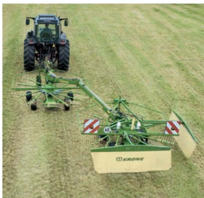
In Position für die Einschwadablage nach rechts: Ideal für Bergemaschinen mit großer Aufnahmekapazität und bei geringem Futterbestand.
