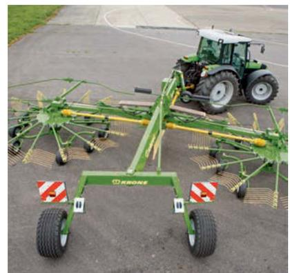
Ernte ohne Verluste: Die Kreiselfahrwerke des Swadro 1000 haben jeweils acht über Tandemfahrwerke geführte Räder. Damit passen sich die Kreisel allen Bodenkonturen optimal an und nehmen das Futter sauber auf. Die frei nachlaufenden Räder folgen auch engsten Kurven.
