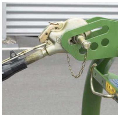
Bestens geführt: Unterschiedliche Lochsegmente gewährleisten eine optimale Führung des Kreisels unter allen Voraussetzungen. Die Anhängung des Oberlenkers im Langloch ermöglicht den Einsatz mit einem vorderen Stützrad.
