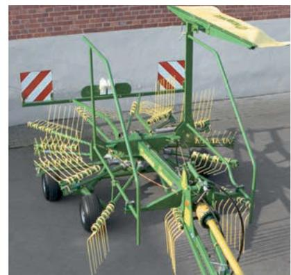
Schmal für den Transport: Leicht lassen sich die seitlichen Zinkenarme beim Swadro 46 T einklappen. So ist diese Einheit kompakt und bietet Sicherheit auf der Straße.
