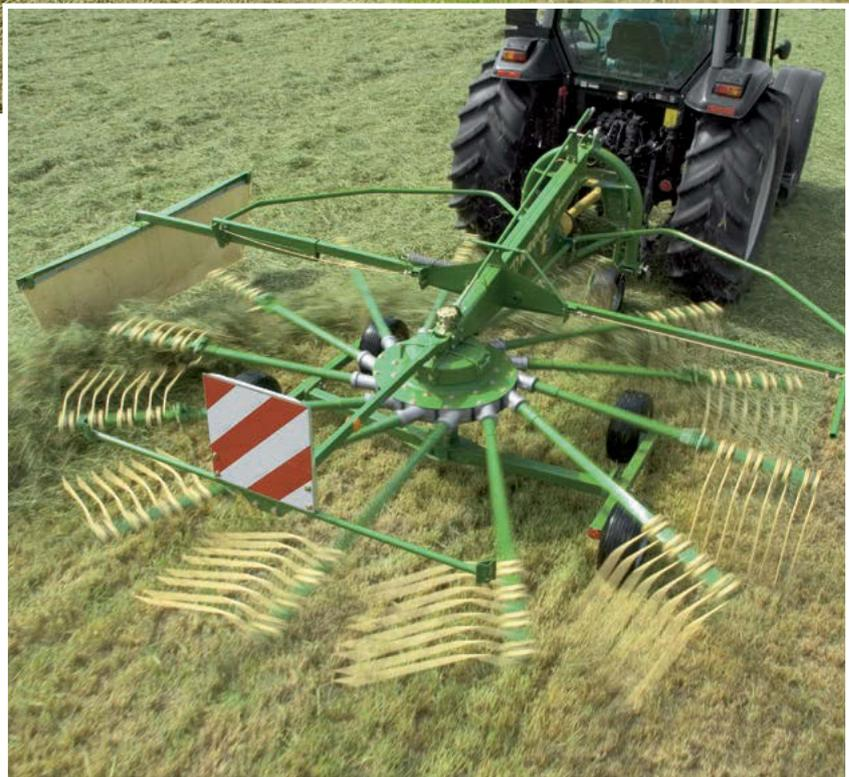
Perfekte Arbeit: Die Einkreiselschwader Swadro 35 bis 46 legen mit bis zu 13 tangential angeordneten Zinkenarmen das Erntegut sauber in gleichmäßige Schwaden ab. Da bleibt nichts liegen.
