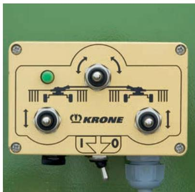
Komfortabel: Die elektrische Bedienbox für den Swadro 700 Plus, 800/26 Plus und 900 Plus. Sie erfüllt zwei Funktionen: Die Einstellung der Arbeitstiefe über Elektromotoren und die Vorwahl der Einzelkreiselaushebung rechts und links.
