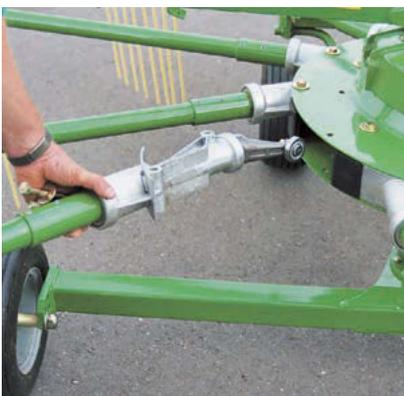
Schnell und einfach: Der Ein- und Ausbau des kompletten Zinkenarmes mit Lagerung und Steuerrolle. Nach Demontage von nur zwei Schrauben lässt sich die komplette Einheit aus dem Kreisel ziehen. Nach Entfernung von zwei Hohlspannstiften ist auch das äußere Armende austauschbar.
