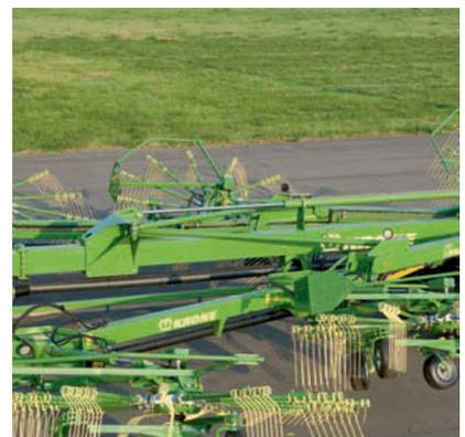
Bestens geführt: die Schwenkarme werden an ihren äußeren Enden von frei nachlaufenden Stützrädern mit 15.0/55-17/10 Bereifung getragen. Für den Transport werden die Räder nach oben geschwenkt. Die Arme werden auf dem Hauptrahmen abgelegt und verriegelt.
