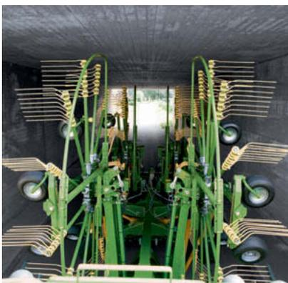
Vom Traktorsitz aus in Transportstellung: Aufgrund der hydraulisch in der Höhe verstellbaren Achse ist der Swadro 1400 Plus mit starren Zinkenarmen ausgerüstet. Das Einklappen der Zinkenarme für den Transport unter 4,00 m erübrigt sich.
