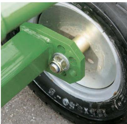
Einstellung der Querneigung: Schnell und einfach lassen sich die Kreisel über Lochsegmente an den hinteren Rädern der Tridemachse einseitig in der Tiefe verstellen, so dass auch bei schwerstem Futter nichts liegen bleibt.
