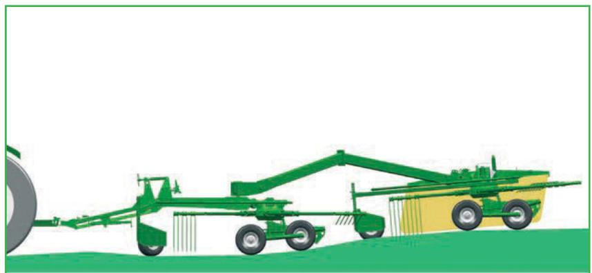
Geniale Lösung: Die kardanische Anlenkung des vorderen Kreisels über die Schwimmstellung des in der Deichsel integrierten Hydraulikzylinders und des hinteren Kreisels über das Langloch an der Kreiselaufhängung. Das überzeugende Resultat: Große Pendelwege für beste Kreiselführung.
