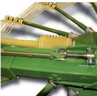
Flexibel in der Schwad- und Arbeitsbreite: Der Swadro 800/26 und 900 haben serienmäßig die mechanische Arbeitsbreitenverstellung. Per Spindel lassen sich die Kreisel leicht ein- und ausfahren. Optional gibt es die hydraulische Arbeitsbreitenverstellung.
