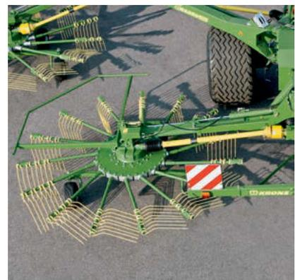
Stark im Antrieb, gering im Leistungsbedarf, übersichtlich im Aufbau: Die Kreiselantriebe erfolgen über das mittig angeordnete Zentralgetriebe. Diese Bauweise ermöglicht weniger und kürzere Gelenkwellen. Die Kreisele sind jeweils einzeln gegen Überlastung abgesichert.
