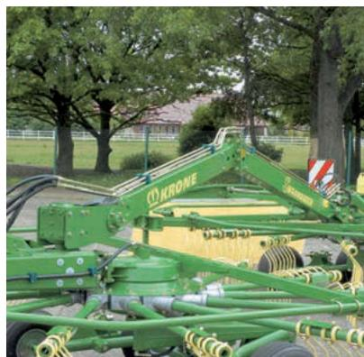
Der hält was aus: Der Hauptrahmen mit seinem Vierkantprofil ist stabil ausgelegt und hält harten Belastungen stand. Das gibt Sicherheit bei schneller Fahrt auf unbefestigten Wegen und bei der Arbeit unter schwierigen Einsatzbedingungen.
