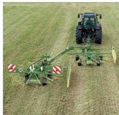
In Position für die Zweischwadablage nach links: Ideal für Bergemaschinen mit geringer Aufnahmekapazität, bei voluminösem Futter, viel Masse oder zum Nachtschwaden.
