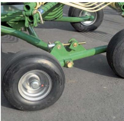
Die Tandemachse mit großdimensionierter 18" Super-Ballon-Bereifung serienmäßig: Damit auch bei schwerem Futter nichts liegen bleibt, kann die Querneigung über eine Spindel eingestellt werden.
