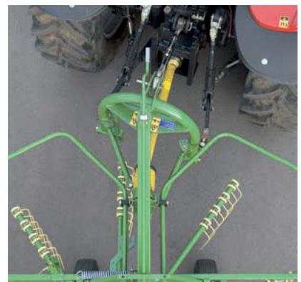
Immer die optimale Schwadbreite: Die Einstellung des Schwadtuches ist einfach. Je nach Futtermenge, aber auch gewünschter Schwadbreite lässt sich das Schwadtuch über ein Teleskopgestänge leicht herausziehen oder hineinschieben.
