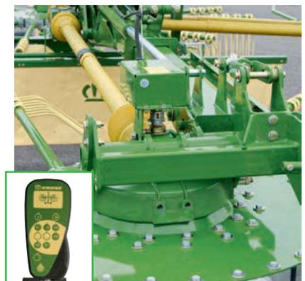
Für hohe Leistung, Stabilität und Komfort: Der wartungsfreie Kreisel mit 15 Zinkenarmen, die Kurvenbahn Dura-Max, die großen und dauergeschmierten Steuerrollen und der große Abstand der Rillenkugellager in den Zinkenträgerlagergehäusen aus Aluminium.
