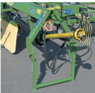
**Basis für lange Lebensdauer:** Der Zweipunktbock (Kat I/II) ist stabil ausgelegt und pendelnd aufgehängt. Die Gelenkwelle kann beim versehentlichen Ausheben der Unterlenker nicht beschädigt werden.
