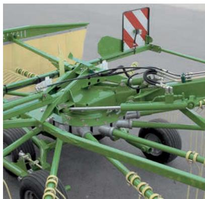
Hinterer Kreisel nach links – hinterer Kreisel nach rechts: das geht schnell und einfach per Schwenkzylinder vom Traktorsitz aus. Über den Schwenkzylinder lässt sich auch die Arbeitsbreite bei Einzelschwadablage variieren.
