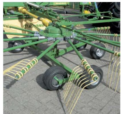
Bestens geführt: Optional zusätzliche Räder für die Tridemachse. Damit verhält sich die Hinterachse wie ein Tandemaggregat, gleicht aus und sorgt für sauberste Recharbeit auch bei großem Kreiselumfang.
