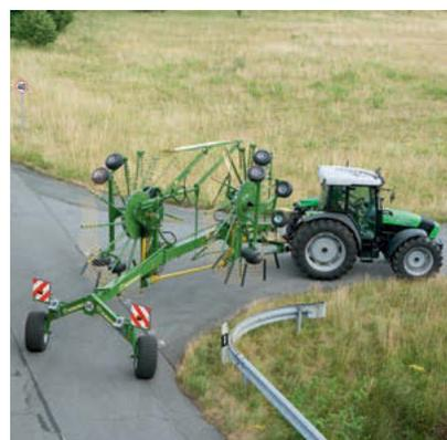
Vom Traktorsitz aus: Die hydraulische Schwadthuchverstellung in Fahrtrichtung am linken Kreisel. Diese komfortable Vorrichtung ermöglicht eine geringe Transporthöhe und die optimale Anpassung an unterschiedliche Futterarten und -massen.
