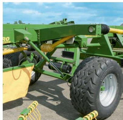
Hydraulisch unter 4,00 m Höhe: Mit der hydraulisch in der Höhe verstellbaren Achse kann der Swadro 1400 für Transportfahrten bequem, einfach und schnell abgesenkt werden. Das spart Zeit und macht die Maschine noch komfortabler.
