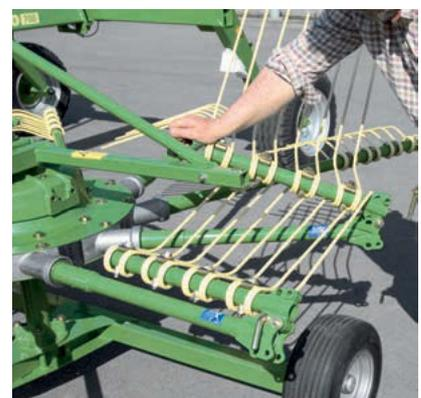
Breit auf dem Feld, niedrig beim Transport: Mit klappbaren Zinkenarmen sind Sie beim Unterqueren von niedrigen Durchfahrten und Brücken stets auf der sicheren Seite. Das Einklappen der Arme ist leicht und geht schnell.
