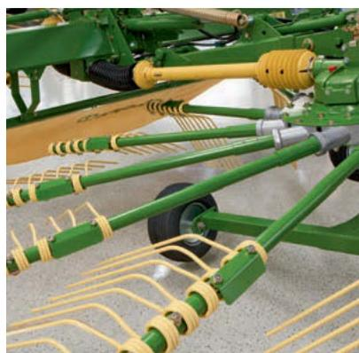
Mit starren Armen: Die Kreisel der KRONE-Mittelschwader Swadro 700 und 800/26 können komplett mit starren Zinkenarmen ausgerüstet werden. Diese Variante bietet sich dort an, wo die Transporthöhe nicht entscheidend ist.
