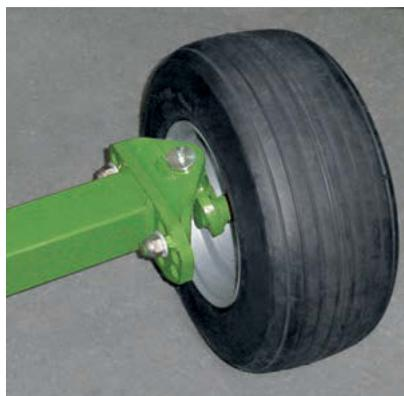
Ideal in Kurven: Optional können die Tridemachsen mit nachlaufenden hinteren Rädern ausgerüstet werden. Sie folgen allen Kurven, radieren nicht, schonen die Grasnarbe und entlasten des Fahrwerk.
