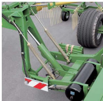
Mit Federentlastung: Zugfedern verlagern einen Großteil des Gewichtes der vorderen Auslegearme und Kreisel auf den Hauptrahmen. Das verhindert ein Absacken der Kreisel auf feuchten Böden und sichert höchste Spurtreue in Hanglagen.
