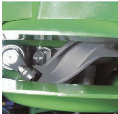
Für eine perfekte Schwadablage: Die Steuerung der Zinkenarme erfolgt über großdimensionierte, dauergeschmierte Steuerrollen. Die Kontur der Kurvenbahn steht für eine saubere Arbeit und muster­gültig geformte kastenförmige Schwaden.
