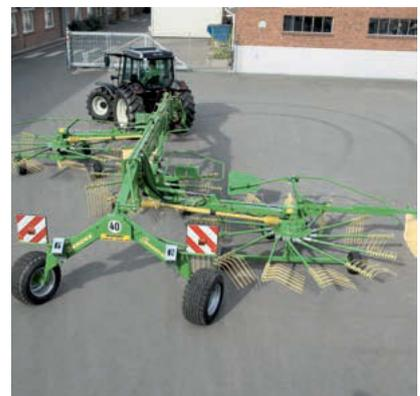
Schmutz im Futter? Nein danke! Wechselnde Einsatzverhältnisse erfordern oft eine unverzügliche Einstellung der Arbeitstiefe. Das funktioniert während der Fahrt über wetterfeste elektrische Stellmotoren, die vom Fahrer über eine elektrische Bedienbox eingestellt werden.
