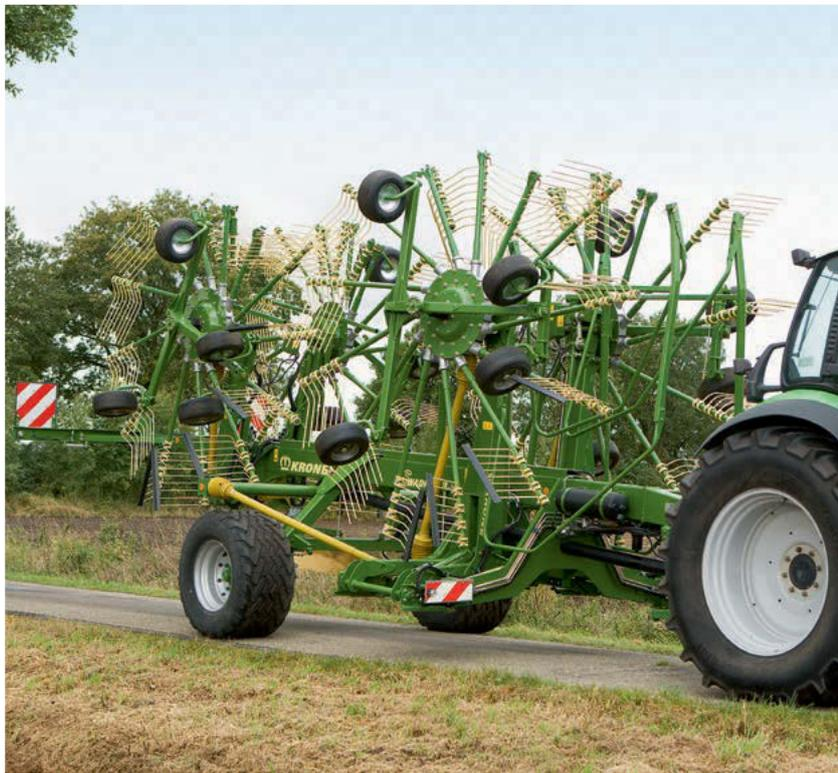
Breit auf dem Feld, kompakt auf der Straße. Die Druckluftanlage, das für 40 km/h zugelassene Breitspurfahrwerk mit großvolumiger Bereifung und die Transportbreite von unter 3,00 m geben Ihnen Sicherheit bei schneller Fahrt auf der Straße. Mit eingeklappten Zinkenarmen und mit nach vorne hin abgesenktem Rahmen hat der Swadro 1400 eine Transporthöhe von unter 4,00 m. Damit liegen Sie in der Norm und haben keine Probleme mit Unterführungen, Stromleitungen und Ästen.
