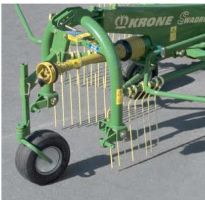
Perfekt geführt: Als Sonderausrüstung gibt es ein zusätzliches, höhenverstellbares und nachlaufgelenktes Stützrad. Damit passt sich der Kreisel vor allem auf unebenem Untergrund noch besser den Bodenkonturen an.
