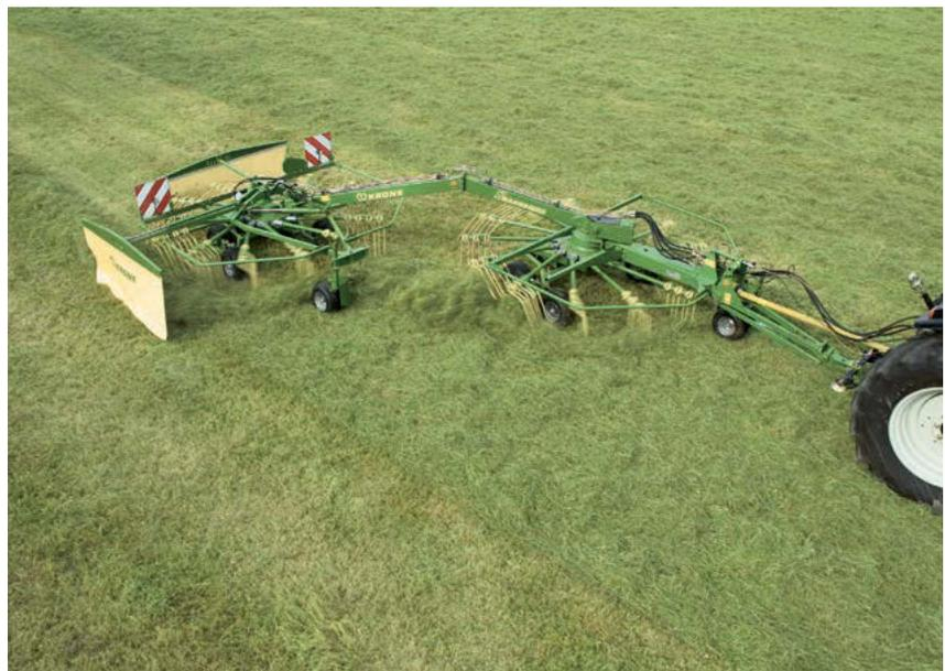
Perfekt – für die Schwadablage nach rechts: Da die Bedienelemente in der Traktorkabine ebenfalls rechtsseitig angeordnet sind, bieten diese Schwader höchsten Fahrkomfort.
