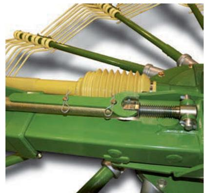
Manuell: Beim Swadro 700 Plus erfolgt die Breitenverstellung über eine Spindel an den Teleskoparmen. Mit der Breitenverstellung wählen Sie die Arbeits- und Schwadbreite – ideal für nachfolgende Erntemaschinen.
