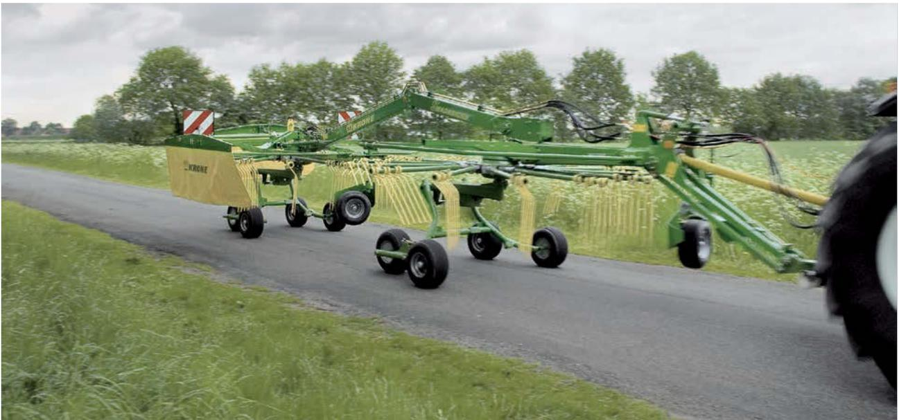
Zugelassen für 40 km/h: Schnelles Umsetzen und damit geringere Transportzeiten sind wesentliche Kriterien, welche die Schlagkraft einer Maschine erhöhen. Die breit ausgelegten Tandemachsen mit 18"-Bereifung bieten ideale Voraussetzungen für hohe Fahrgeschwindigkeiten.
