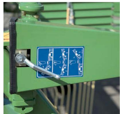
Mit optimaler Arbeitstiefe: Die Arbeitstiefeneinstellung der Kreisel erfolgt beim Swadro 700, 800/26 und 900 stufenlos und bequem über Spindel. Die exakte Einstellung steht für eine verlustfreie und saubere Futteraufnahme.
