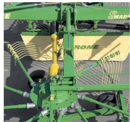
Mit gezogenen Kreiseln: Der hinter dem Auslegearm positionierte Kreisel führt in Verbindung mit der kardani-schen Anlenkung zu einem idealen Aushubverhalten. Vorteil: Die Zinken können die Grasnarbe nicht beschädigen.
