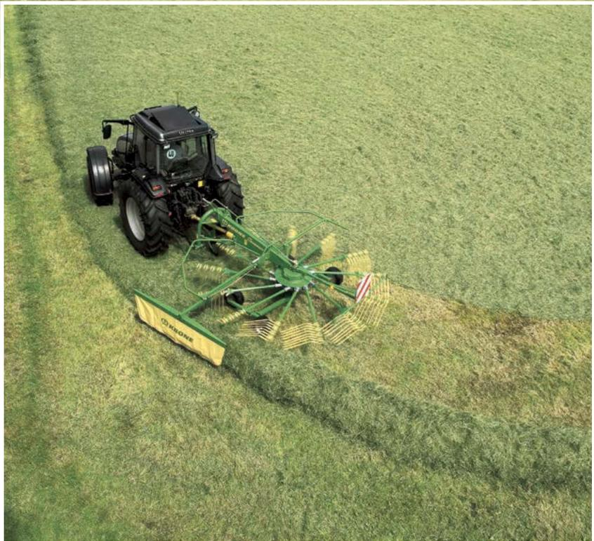
Wendig – durch und durch: Alles geht mit. Denn mit einem Lenkeinschlag von 20° geht es auch in den Ecken rund. Der nachlaufende Kreisel lässt nichts liegen und formt auch in Kurven perfekte Schwaden. Ein entscheidender Pluspunkt, denn der KRONE Einkreiselschwader Swadro wird vielfach auf kleinen, verwinkelten Flächen eingesetzt.
