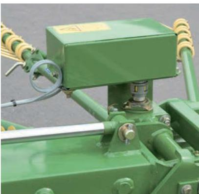
Vom Traktorsitz aus: Die elektrischen Stellmotoren ermöglichen die schnelle Einstellung der Arbeitstiefe während der Fahrt. Damit arbeiten Sie stets optimal, ernten sauber und haben keine Futterverluste.
