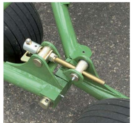
Für die sichere Anhängung im Zugpendel oder in der Ackerschiene: Die Deichsel ist höhenverstellbar, die Zugöse parallelogrammgesteuert. Der Hydraulikzylinder an der Deichsel hält den vorderen Kreisel beim Einsetzen und Ausheben waagrecht.
