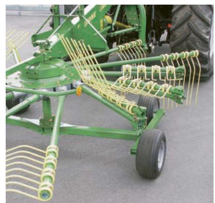
Komfortabel und automatisch: Zum Transport wird die Maschine ausgehoben. Dabei fahren die Dämpferstreben auf Anschlag und halten den Kreisel mittig hinter dem Dreipunktbock. Hier muss nichts per Hand verriegelt werden.
