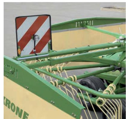
Komfortabel: Die hydraulische Schwad-tuchverstellung am hinteren Kreisel. Die Verstellung für unterschiedliche Schwad-breiten erfolgt vom Traktorsitz aus. Für den Straßentransport wird das Tuch hydraulisch eingezogen.
