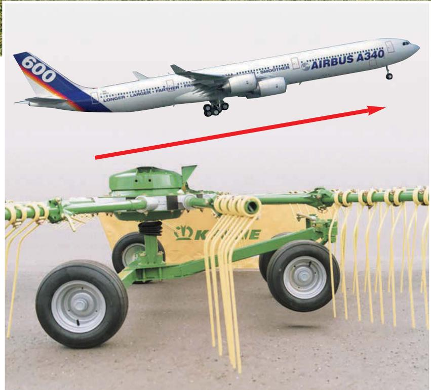
**Der KRONE Jet-Effekt:** Sauber landen, sauber starten! Die gezogene Kreiselanlenkung, kombiniert mit der kardani-schen Aufhängung, macht Sinn: Beim Ablassen der Kreisel setzen zuerst die hinteren Räder, dann die vorderen Räder der Tridemachse auf – beim Ausheben in umgekehrter Reihenfolge. Deshalb können die Zinken beim Absetzen und Ausheben weder durch den Boden laufen, die Grasnarbe beschädigen, noch das Futter verschmutzen. Diese KRONE Lösung garantiert qualitativ hochwertiges Futter.
