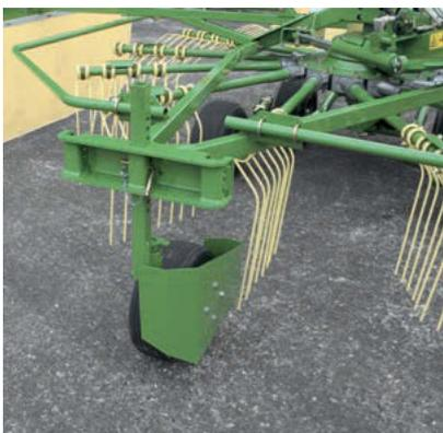
Vordere Stützräder für die perfekte Kreiselführung in Kombination mit der kardani-schen Anlenkung: Sie sind nachlaufend, in der Höhe verstellbar und können je nach Futtermenge zusätzlich seitlich versetzt werden.
