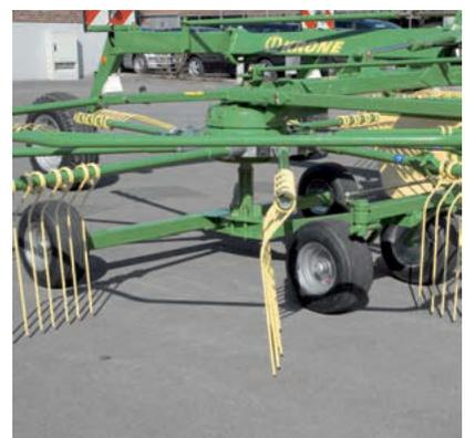
**Breit in der Spur:** Die Tridemachse schont die Grasnarbe und steht für sauberes Futter. Die vorderen Räder sind nachlaufgelenkt und mit einer Spurstange verbunden. Das gibt Laufruhe. Die starren Hinterräder stabilisieren das Fahrverhalten am Hang.
