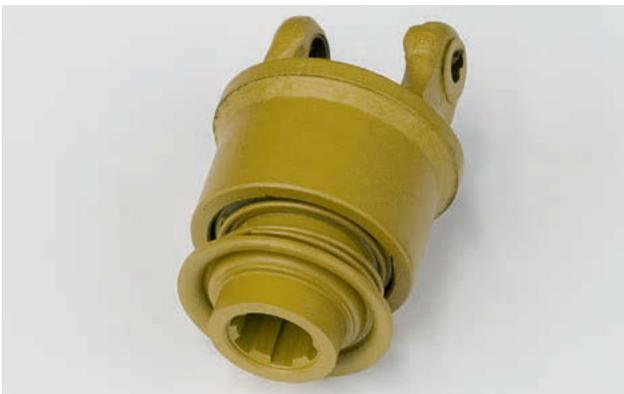
**Freilauf:** Die Swadro 35, 38, 42 und 46 können optional mit einem Freilauf an der Gelenkwelle ausgerüstet werden, ideal für den Einsatz von Traktoren mit Zapfwellenbremse. Der Freilauf schont beim Abschalten der Zapfwelle Traktor und Maschine.
