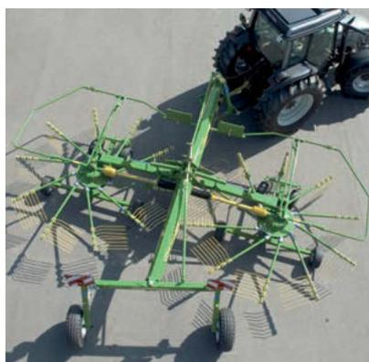
**Zwangsgelenkt:** Das Breitspurfahrwerk mit großvolumiger Bereifung 10.0/75-15.3/8 PR wird vom Zweipunktbock aus über eine stabile Spurstange angelenkt. Das garantiert beste Nachlaufeigenschaften, auch in engsten Kurven.
