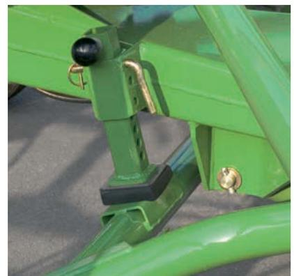
Verklemmen der Zugöse? Nicht mit der Parallelogrammsteuerung an der höhenverstellbaren Zugdeichsel für die Ackerschne oder dem Zugpendel. Der Hydraulikzylinder an der Deichsel hält den Kreisel beim Einsetzen und Ausheben waagrecht.
