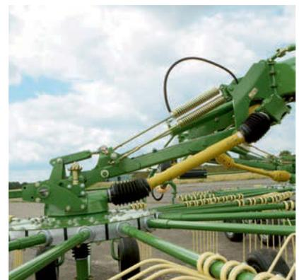
Perfekt – auch in schwerem Futter: Die großen geschlossenen Kreisel mit jeweils sechs nachlaufenden Rädern, die optionale elektrische Tiefenverstellung und die Einstellung der Querneigung über Lochsegmente ermöglichen die saubere Arbeit bei hoher Leistung.
