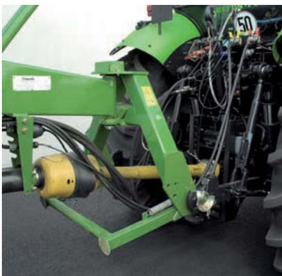
Stabil und durchdacht: Der Zweipunkt-Bock ist pendelnd aufgehängt und kann sich allen seitlichen Traktorbewegungen anpassen. Beim versehentlichen Ausheben der Traktorunterlenker kann die Gelenkwelle nicht beschädigt werden.
