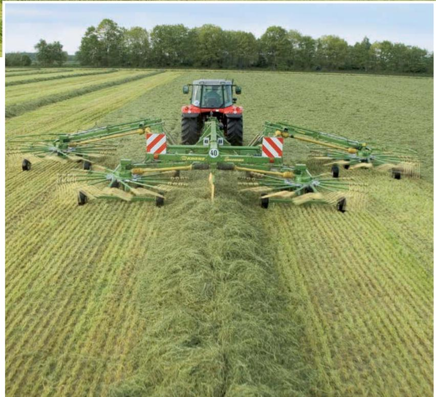
Das sehr gleichmäßige Mittelschwad des Swadro 1400 sorgt für eine noch bessere Auslastung nachfolgender Erntemaschinen. Lohnunternehmer sprechen von einer bis zu 20 % höheren Aufnahmeleistung ihrer Häcksler. Der Swadro 1400 steckt voller innovativer Ideen, wie zum Beispiel die kardanische Kreiselanlenkung, der KRONE Jet-Effekt, die speziell gehärtete Kurvenbahn Dura-Max mit 3 Jahren Garantie und die Arbeitstiefenverstellung über elektrische Stellmotoren.
