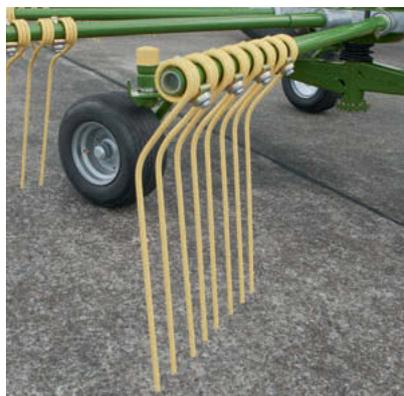
Für die saubere Arbeit: Mit bis zu fünf Nachlauf-Doppelzinken pro Zinkenarm. Die dickwandigen Arme und bis zu 10,5 mm starken Zinken und der große Durchmesser der Windungen stehen für eine hohe Lebensdauer, Elastizität und Stabilität.
