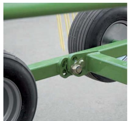
Auf großem Fuß: Der Swadro Einkreiselschwader ist mit seiner Super-Ballon-Bereifung 16 x 6.50/6 ply bestens gerüstet. Diese Bereifung steht nicht nur für gute Laufeigenschaften, sondern schont auch die Grasnarbe.
