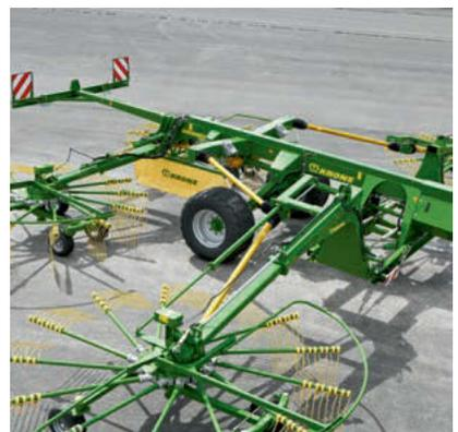
Das mittlere Schwadttuch optional: Damit legen Sie auch mit einseitig ausgehobenen Kreiseln ein perfektes Schwad ab. Für die Transportstellung schwenkt das Tuch automatisch nach oben. Das bringt Bodenfreiheit.
