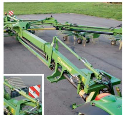
**Robust:** Der Swadro 2000 wird von den Unterlenkern des Traktors gezogen. Der bewegliche Anhängelock Kat II/III gleicht Bodenunebenheiten aus. Der stabile Stützfuß sorgt für hohe Standsicherheit. Die Gelenkwelle und Leitungen werden sauber in Halterungen abgelegt.
