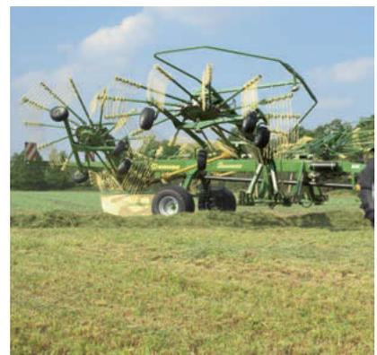
Freiraum satt: Die Anlenkung der Auslegearme und die waagerechte Stellung des Hauptrahmens ermöglichen einen weiten Aushub. Dank der Folgeschaltung werden immer zuerst die vorderen Kreisel ausgehoben oder abgelassen.
