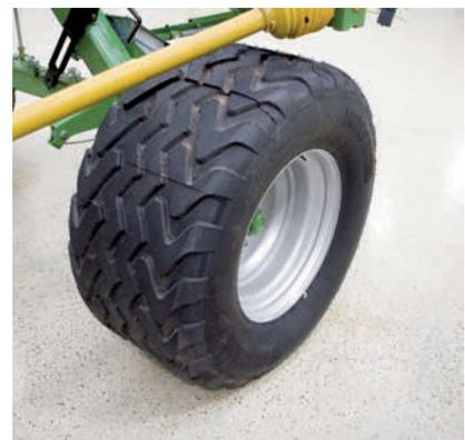
Sie können wählen: Serienmäßig die Bereifung 500/50-17/10 PR, optional die größere Bereifung 560/45-22.5, die sich für das Transportfahrwerk auf nachgiebigem Untergrund bestens bewährt hat. Beide Varianten sind für 40 km/h zugelassen
