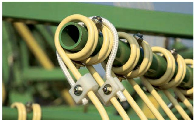
**Zinkenverlustsicherung** für alle KRONE Kreiselschwader. Bei Bruch wird der Zinken von der Sicherung gehalten. Er geht nicht im Schwad verloren und kann somit keine Folgeschäden verursachen.
