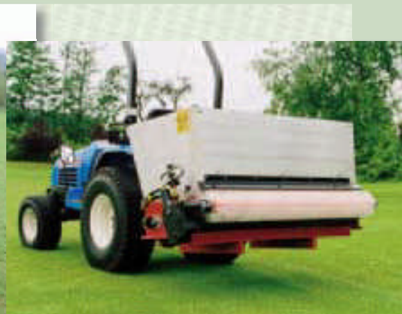
Der Rink 1005 wird in die Dreipunkt Schlepper angebaut und hat ein Volumen von 0.75m 3 .
