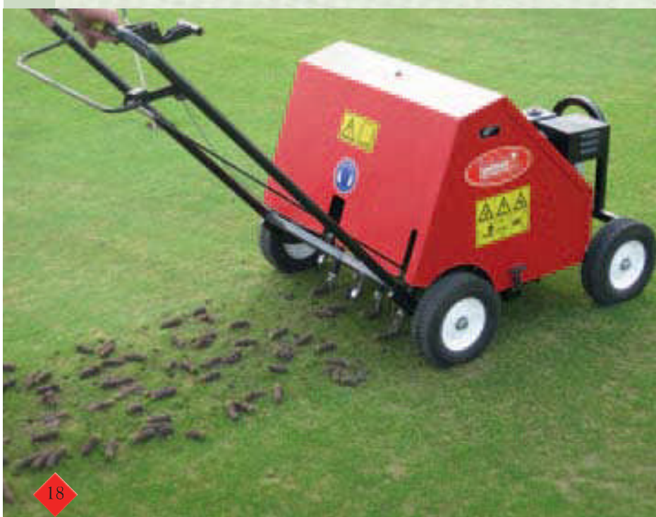
Die Modelle 104, 106 und 108 haben keinen eigenen Antrieb und besitzen 4, 6 bzw. 8 Zinkenarme, während das Modell 208 selbstfahrend ist und 8 Zinkenarme besitzt.
