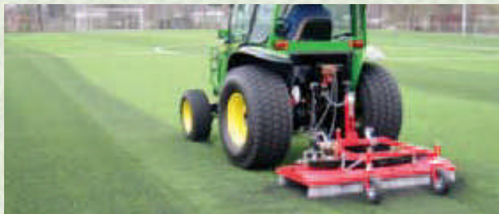
Die 5 rotierenden Bürsten drehen mit hoher Geschwindigkeit.
