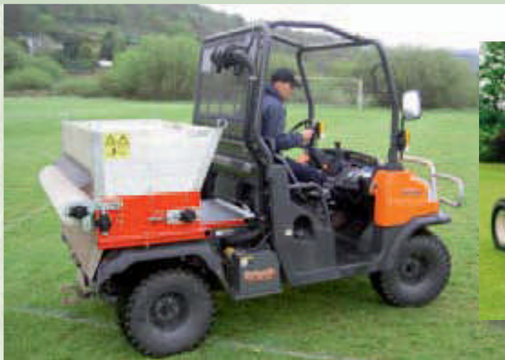
Kubota RTV mit dem speziell gebauten Rink 1003 mit einem Volumen von 0.4m 3 .
