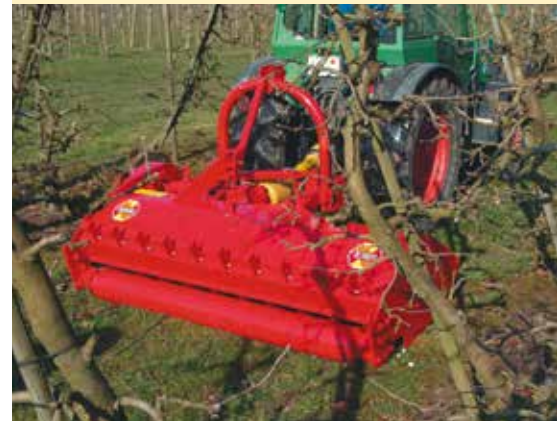
KM mit Aufnahme- und Zerreißvorrichtung zum Holzzerkleinern.
