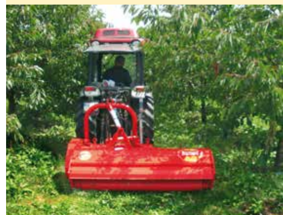
KM mit Aufnahme- und Zerreißvorrichtung zum Holzzerkleinern.
