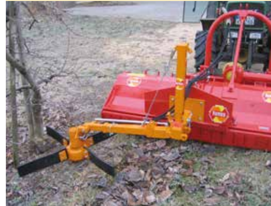
Der Holzschwader / Gummilappenrotor zum Reinräumen des Schnittholzes kann an verschiedene humus-Maschinentypen für Front- und Heckanbau montiert werden. Der Holzschwader/Gummilappenrotor ist für den Anbau am KMN geeignet.
