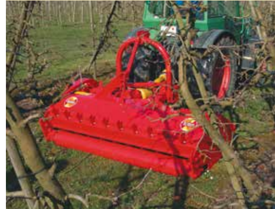
KMN mit Aufnahme- und Zerreißvorrichtung zum Holzerkleinern.
