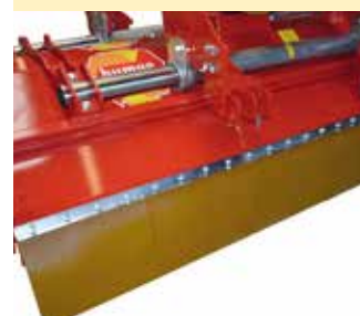
Zusätzlicher Gummi-Steinschlagschutz im Heckbereich
