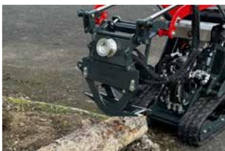
Le grappin forestier est équipé d'un cabestan hydraulique permettant le débardage sans démontage de l'outil. Idéal pour des rétentions délicates, ce cabestan vous permettra également de désenchevêtrer des arbres tombés en toute sécurité.
