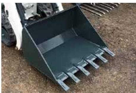
Godet de terrassement avec dents et lame d'attaque. Permet de décavaillonner et de charger les sols difficiles. Attention, ce godet n'a pas la «polyvalence» d'un godet chargeur vrac, notamment pour les capacités de nivelage en marche arrière.
