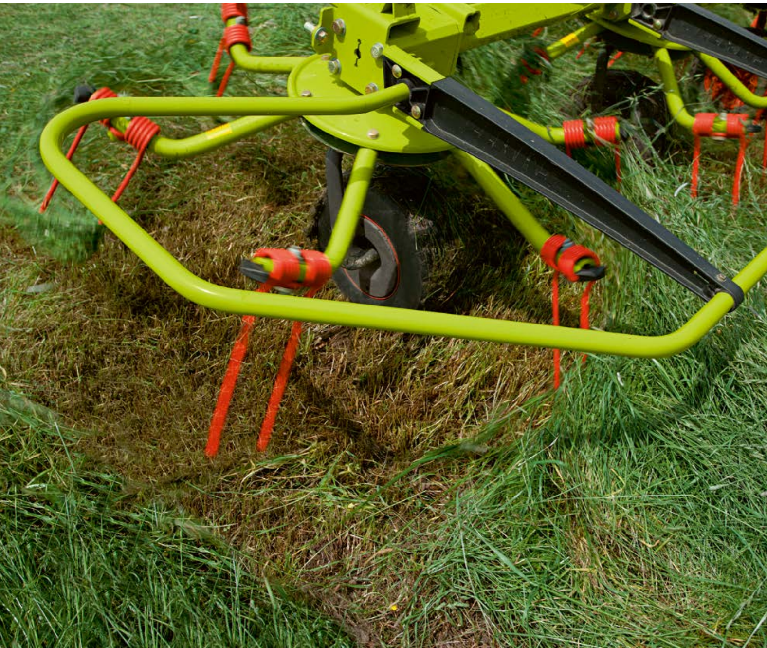
Saubere Rechenarbeit: die Gutaufnahme erfolgt in kleinen Portionen.
