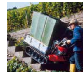
Der HP 500 verfügt auch am Hang über genügend Traktion
