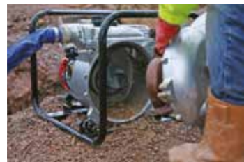
Der abnehmbare Inspektionsdeckel ermöglicht einen leichten Zugang
