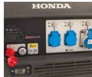
Drücken Sie die Starttaste um den Motor zu starten
