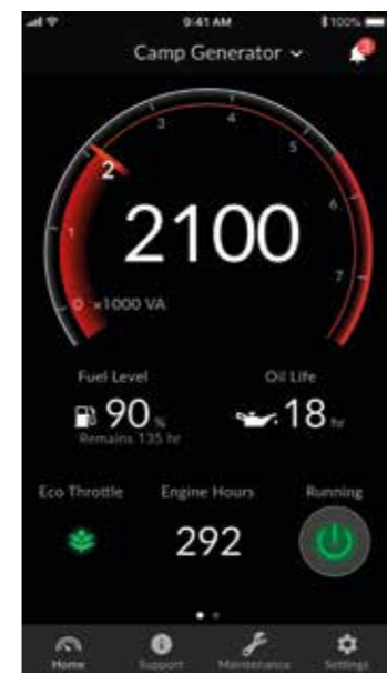
Mit der intelligenten App haben Sie Zugriff auf Funktionen wie die Kraftstoffanzeige und die Betriebszeit sowie auf Wartungshinweise.
