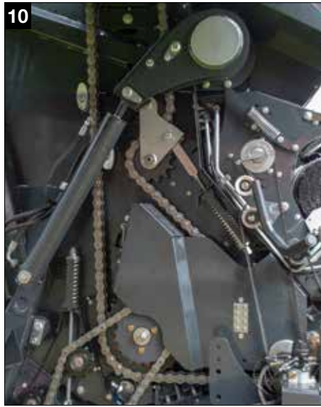
10 La transmission robuste est dotée de chaînes surdimensionnées résistantes à l'usure
