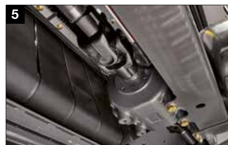
Arbres d'entraînement avec joints de cardan intégrés
