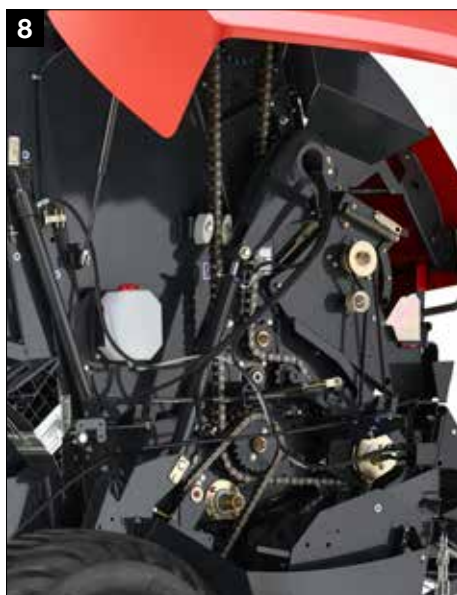
8 Transmission robuste avec chaînes IWIS de qualité supérieure, transmission primaire 1¼" 20BH avec broches en chrome durci
