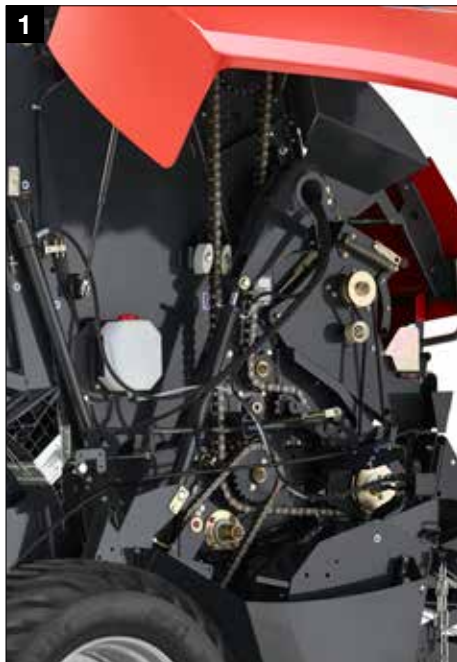
Transmission robuste avec chaînes IWIS de qualité supérieure
