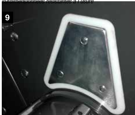
9 Le système i-DENSE breveté* adapte automatiquement la pression du pressage en fonction du taux d'humidité
