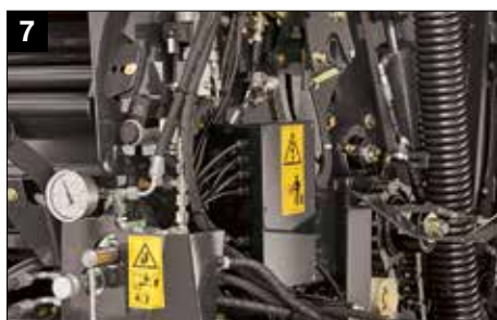
7 Valve proportionnelle pour un contrôle de la densité en cabine
