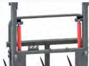
Gute Durchsicht durch zwei außen angebrachte Hubzylinder
