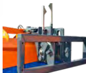
Niveaueingleich inkl. Höhenanzeige (sperrbar)
