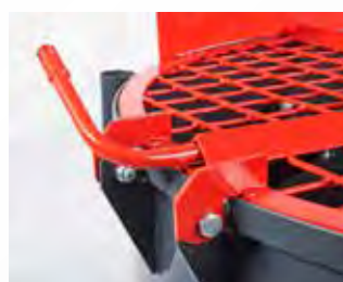
3/4" Anschluss zum Beimischen von Wasser
