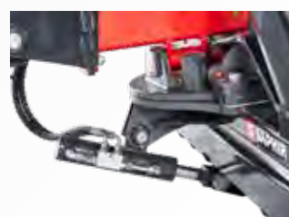
Optionale hydr. Vertikaleinstellung der Schürfleiste +/- 25°
