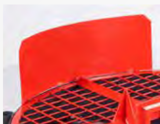
Vorderes Spritzblech zum Schutz des Traktors
