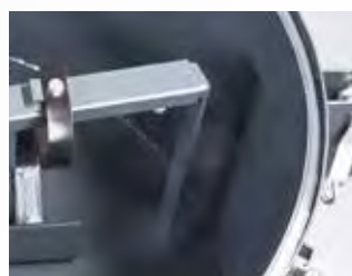
Nachstellbarer Seitenwandabstreifer zur restlosen Entleerung des Mischbehälters.
