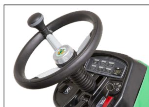
Benutzerfreundliches Armaturenbrett, höhenverstellbare Lenksäule
