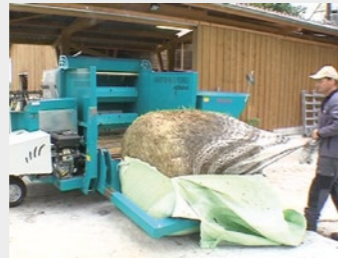
Oberseite: Folie/Netz entfernen
