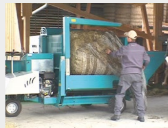
Unterseite: Folie/Netz entfernen
