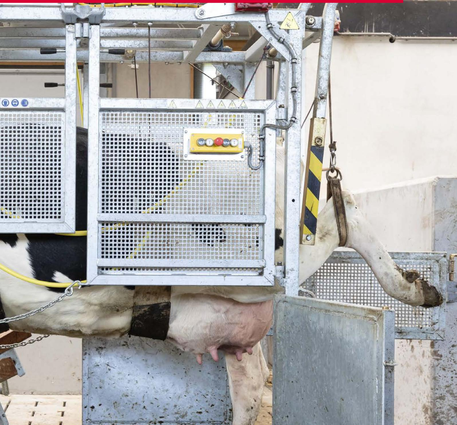
Die Lely Behandlungsbox ermöglicht Dir Zugang zur gesamten Kuh aus verschiedenen Richtungen. Die verschiedenen Elemente an den Seiten der Box können geöffnet oder geschlossen werden. Je nach Behandlung kannst Du die Box so einstellen, dass bestimmte Bereiche der Kuh leichter zu erreichen sind.
