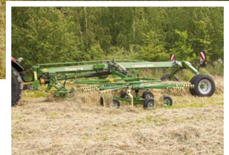
Swadro TC 760 / 760 Plus Zweikreisel-Mittelschwader Variable Arbeitsbreiten von 6,80 m bis 7,60 m
