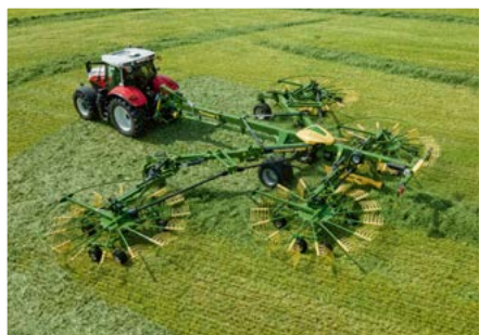
Swadro TC 1570 Vierkreis-Mittelschwader Variable Arbeitsbreiten von 11,00 m bis 15,70 m
