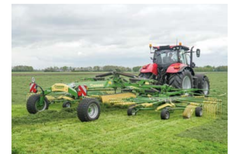
Swadro TC 1000 / 1000 Plus Zweikreisel-Mittelschwader Variable Arbeitsbreiten von 8,90 m bis 10,00 m
