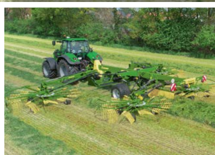
Swadro TC 1370 Vierkreis-Mittelschwader Variable Arbeitsbreiten von 10,80 m bis 13,70 m
