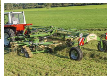
Swadro TC 640 Zweikreisel-Mittelschwader Variable Arbeitsbreiten von 5,70 m bis 6,40 m
