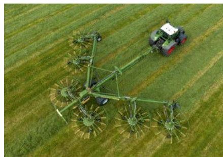
Swadro TC 2000 Sechskreis-Mittelschwader Variable Arbeitsbreiten von 10,00 m bis 19,00 m
