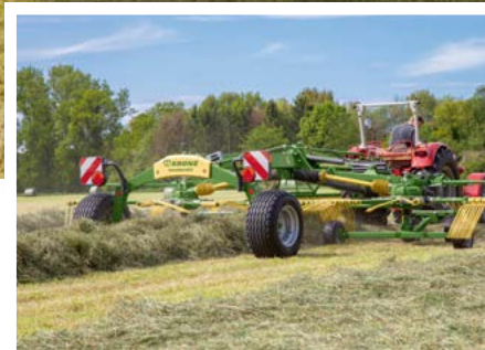
Swadro TC 680 Zweikreisel-Mittelschwader Arbeitsbreite 6,80 m
