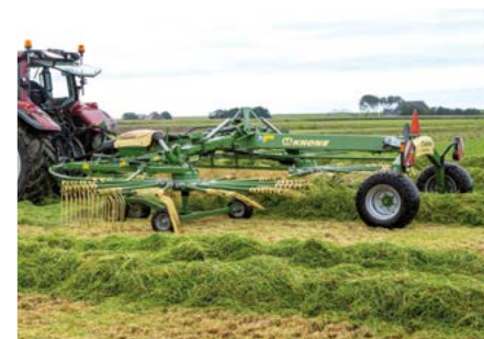
Swadro TC 880 / 880 Plus Zweikreisel-Mittelschwader Variable Arbeitsbreiten von 7,60 m bis 8,80 m
