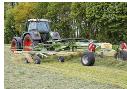
Swadro TC 930 / 930 Plus Zweikreisel-Mittelschwader Variable Arbeitsbreiten von 8,10 m bis 9,30 m
