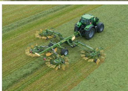
Swadro TC 1250 / 1250 Plus Vierkreis-Mittelschwader Variable Arbeitsbreiten von 9,80 m bis 12,50 m
