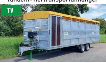
TV 120/140/160/180 - 12/14/16/18 To. innen: 650/700/750/800/920 x 225 cm ohne Radkasten - Räder unter Ladefläche
